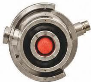
Reinigingsballetje plaatsen in fustkoppeling
